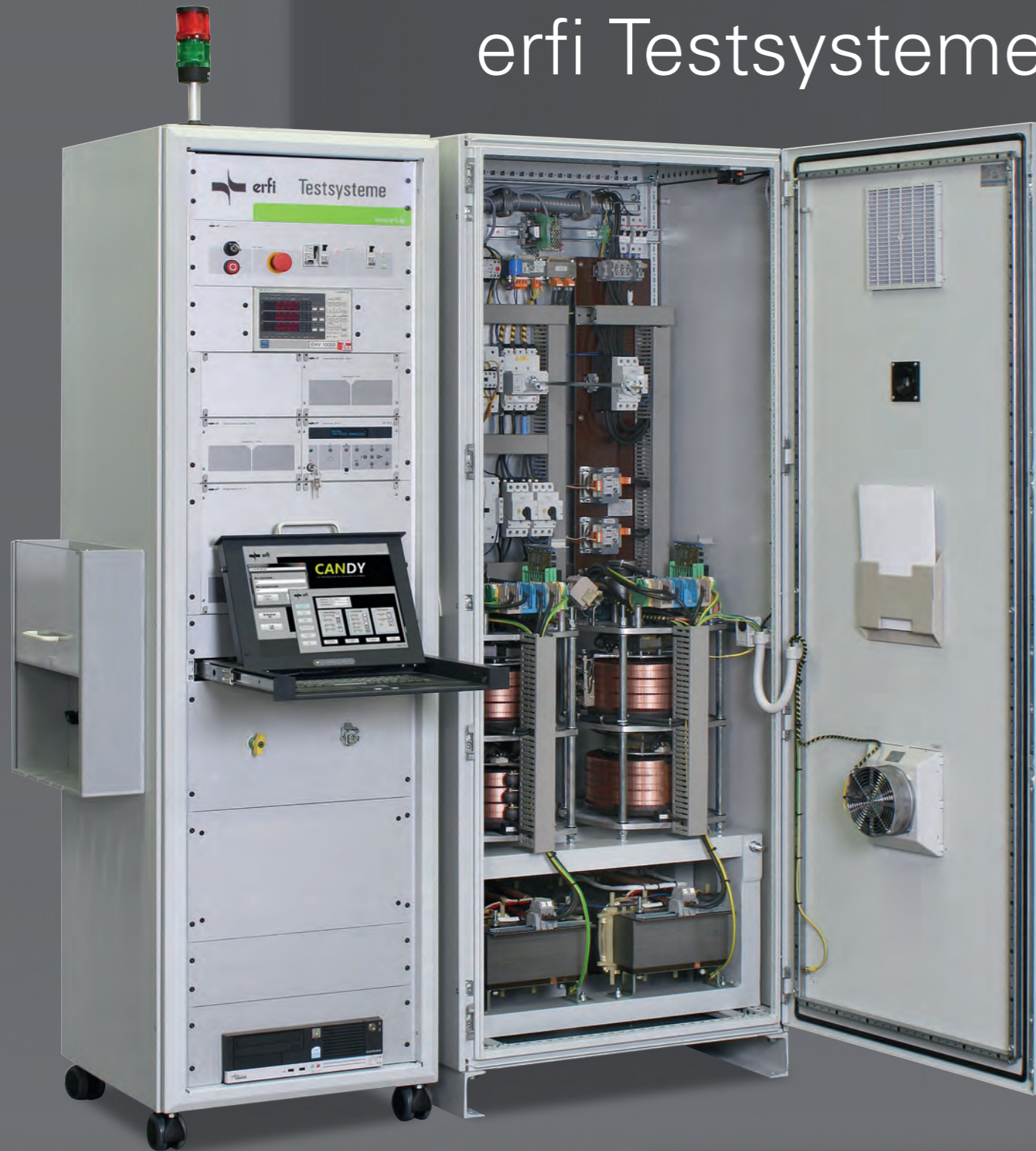
Abbildung zeigt Testsystem für Großküchengeräte mit HV-Warm-, Iso-, PE-, Ableitstrom- und Leistungsprüfung.
