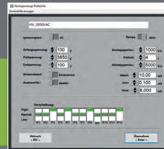
Prüfplan Hochspannung mit Umschaltmatrix
