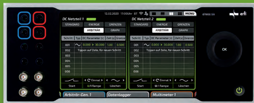
Unabhängige Programmierung: Dank variabler Bildschirmteilung können Doppelleistungsarbiträrgeneratoren unabhängig voneinander programmiert werden.
