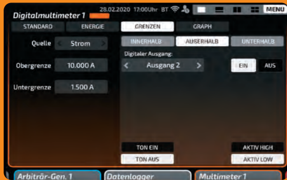
Limiter: Jede Messgröße kann durch definierbare Grenzen mittels Tönen und digitalen Ausgängen überwacht werden. Die digitalen Ausgänge können direkt genutzt werden, um beispielsweise verschiedene Zustände mittels dem erfi- RGB-Indikationslicht anzuzeigen.
