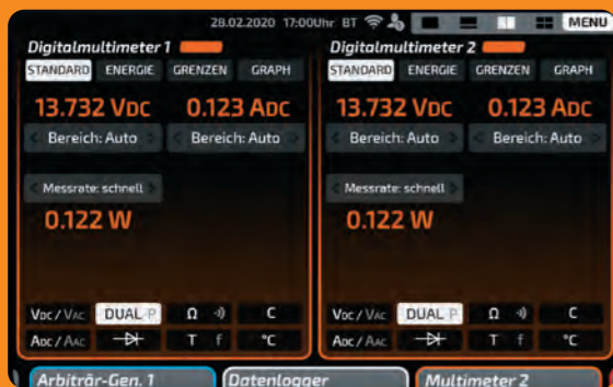
Zwei Digitalmultimeter im Halfscreen: Alle Bedienelemente beider Digitalmultimeter lassen sich gleichzeitig und unabhängig voneinander bedienen. Die optionale Dualmessung ermöglicht jedem Digitalmultimeter die gleichzeitige Erfassung von Strom und Spannung im AC und DC-Bereich.
