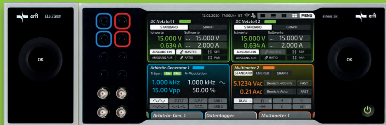
Doppelnetzteil mit 2. zusätzlichem Wheel: Das optionale 2. Wheel kann wahlweise links oder rechts vom Steuerzentrum positioniert werden.
