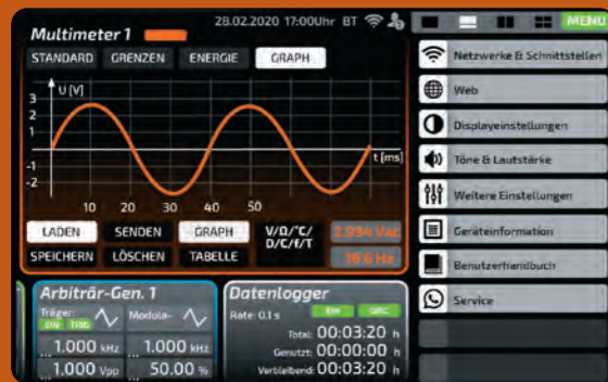
Dynamischer Screeninhalt: Bei Einblendungen von Menüs skalieren sich die Bildschirme automatisch ohne die Geräteanzeigen zu überblenden. So bleiben Sie immer mit allen Geräten verbunden und können während Parametereinstellungen parallel beispielsweise Messwertverläufe verfolgen.
