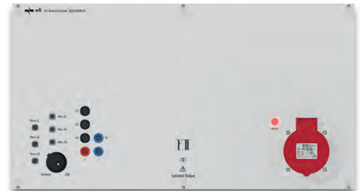
Zusatzeinschub mit Alufrost für AC-Quelle 3-phasig, erdfrei, 6 HE/95 TE Ausgänge (abges.): 4 SLB 1 , 1 CEE-Steckdose 16 A, 2 SLB 1 zur Entnahme von Gleichspannung (Brückengleichrichter ist separat zu bestellen. Bestell-Nr. EL6.AC3.B6, Seite 101) Anzeige: RGB-LED für Ausgang active Best.-Nr. EL6.AC3CB.32
