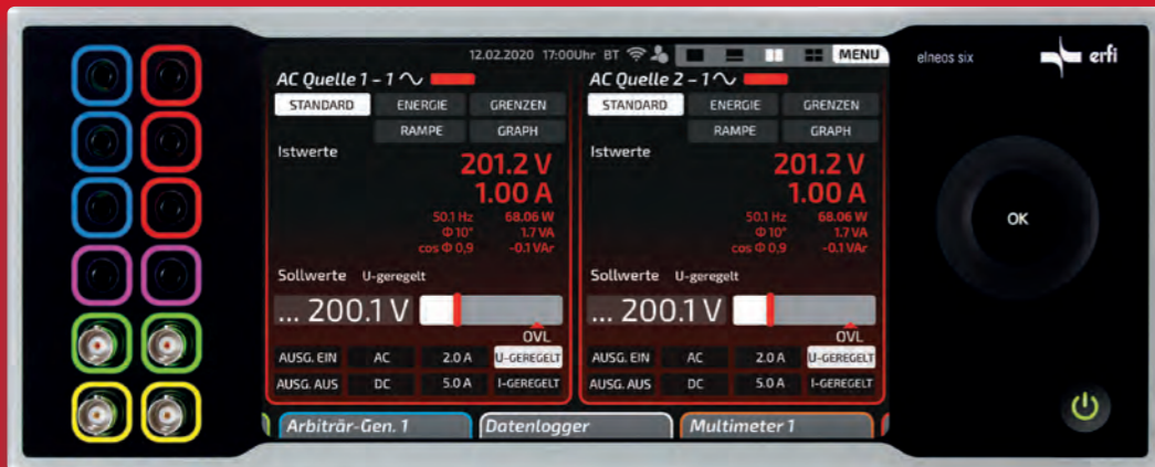
Halfscreen: Beispiel der gleichzeitigen Gerätedarstellung von zwei AC-Quellen im Halfscreen-Modus. Alle anderen Geräte bleiben durch die Geräteaufleiste am unteren Bildschirmrand erreichbar.
