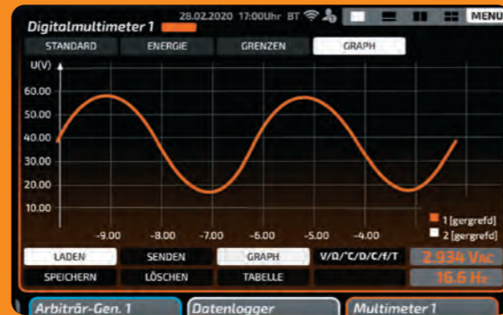
Datenlogger: Die Aufzeichnungsmöglichkeiten sind besonders in Verbindung mit dem neuen 8-Zoll-Display sehr wertvoll. Durch verschiedene Gesten können Kurven schnell und dynamisch in alle Richtungen gezoomt werden.
