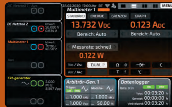
Connectionpanel mit Istwert-Anzeige: Das neue Connectionpanel zeigt alle Messwerte an den Aus- bzw. Eingängen an. Der Screen mit den Geräteanzeigen skaliert sich automatisch. Das Connectionpanel stellt somit einen eigenen Informationsscreen dar, der dauerhaft eingeblendet bleiben kann. Keine Verschiebung der Messwertanzeigen.
