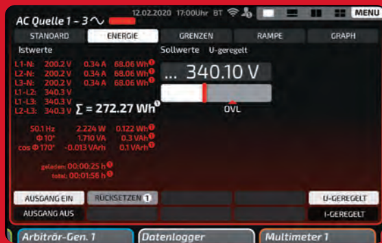
3-phasige AC-Quellen mit Leistungs- und Energiemesser: Bei 3-phasigen AC-Quellen ist ein 3-phasiger Leistungs- und Energiemesser im Lieferumfang beinhaltet. Die Ist-Spannungen zwischen allen Phasen und N werden gleichzeitig angezeigt.
