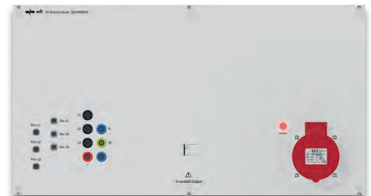
Zusatzeinschub mit Alufrost für AC-Quelle 3-phasig, nicht erdfrei, 6 HE/95 TE Ausgänge (abges.): 5 SLB 1 , 1 CEE-Steckdose 16 A, 2 SLB 1 zur Entnahme von Gleichspannung (Brückengleichrichter ist separat zu bestellen. Bestell-Nr. EL6.AC3.B6, Seite 101) Anzeige: RGB-LED für Ausgang active Best.-Nr. EL6.AC3CB.33
