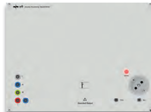
Zusatzeinschub mit Alufrost für AC-Quelle 1-phasig, nicht erdfrei, 6 HE/70 TE Ausgänge (abgesichert): 3 SLB 1 , 1 Schutzkontaktsteckdose, 2 SLB 1 zur Entnahme von Gleichspannung (Brückengleichrichter ist separat zu bestellen. Bestell-Nr. EL6.AC1.B1, Seite 101) Anzeige: RGB-LED für Ausgang active Best.-Nr. EL6.AC1CB.43
