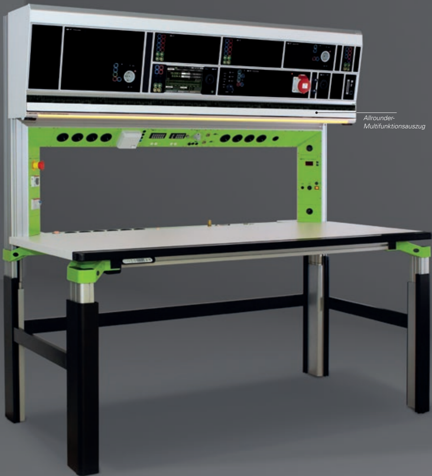
Abbildung 1: Tisch mit 19-Zoll/6 HE-Cockpit, 10° geneigt (Option) und integriertem Allrounder Multifunktionsauszug.
