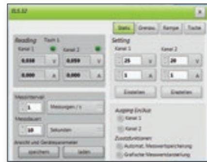
Beispiel DC-Quelle: Netzteil mit Spannungs- und Strombegrenzung ( U_{max} und I_{max} ) sowie automatische Messwertspeicherung.
