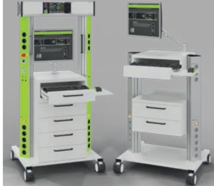
Abbildung 2: Links Energiemobil (B x T x H): 821 x 758 mm x 1600 mm, zzgl. 19-Zoll-Cockpit aus Aluminium oben aufgesetzt. Rechts Energiemobil (B x T x H): 821 x 758 mm x 1100 mm. Beide Mobile mit durchgehendem Expandprofil 2 beidseitig.
