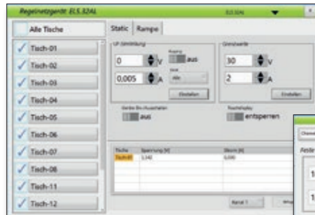
Gleichzeitige Detaileinstellung der Regelnetzgeräte an allen Labortischen.
